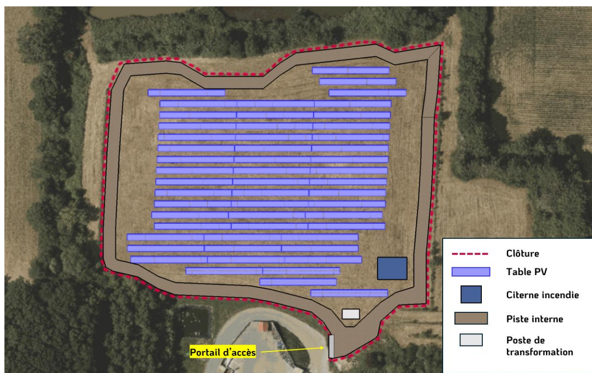
Figure 3 : Plan d'implantation de la centrale
